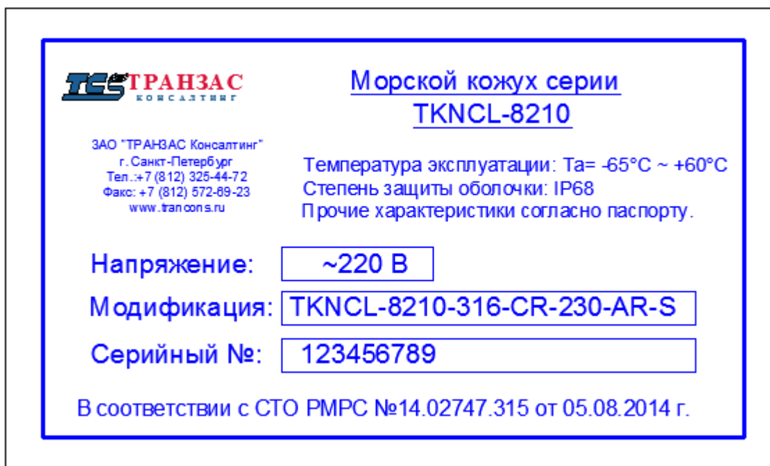
Рис. 2.1.1 – Пример идентификационной таблички на корпусе
