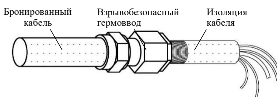
Рис. 3.4.2.2- Сборка бронированного кабеля и взрывобезопасного гермоввода
