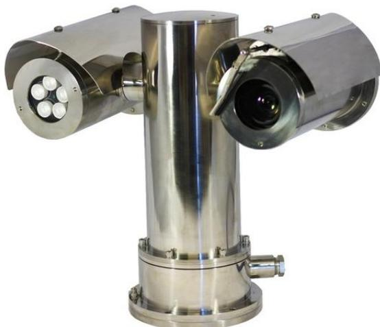
Взрывозащищённая поворотная камера с дворником и козырьком серии TKNPTZ (далее - камера) предназначена для видеонаблюдения в пожаро- и взрывоопасных местах, и помещениях. Камера обеспечивает обзор 360° в горизонтальной плоскости и +/-90° в вертикальной благодаря поворотному-наклонному (PTZ) механизму, а также изменению настроек аналоговой видеокамеры, выполненной на базе матрицы 1/4 Sony EX-View HAD CCD с оптическим увеличением в 36X и цифровым увеличением 12X.
