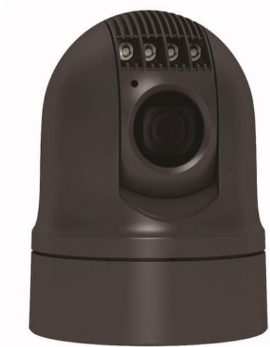
Морская поворотная камера ТКРТЗ-320АW в корпусе IP66 является сертифицированной камерой. Предназначена для круглосуточного и всепогодного наблюдения в морских условиях.
