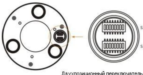
Рис. 1- Двухпозиционный переключатель
