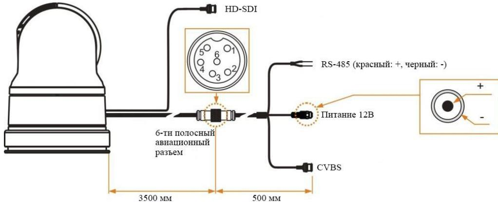
Рис. 12- Схема подключения
