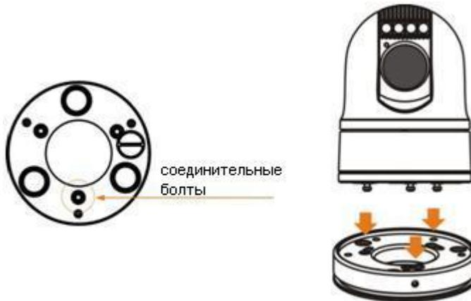
**Рис. 8- Монтаж камеры**
