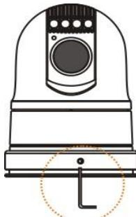
Рис. 9- Фиксирование камеры
