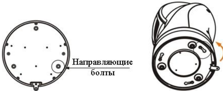
Рис. 4.2.3- Крепление камеры к монтажной панели
