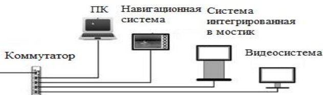
Рис 4.4.5. Схема подключения камеры и оборудования для видеообмена по Ethernet.
