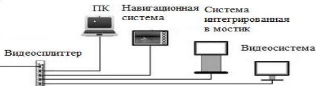
Рис. 4.4.4. Схема подключения камеры и оборудования для вывода изображения.
