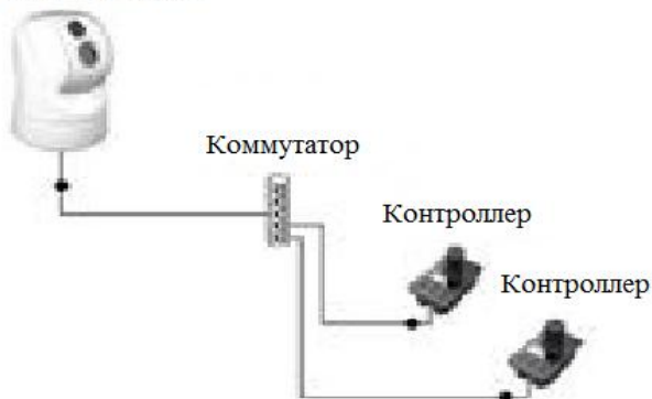
Рис 4.4.2 Схема подключения одной камеры и нескольких пультов управления
