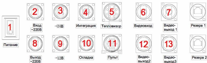
Рис. 5.4.1 Передняя панель блока питания и интеграции
