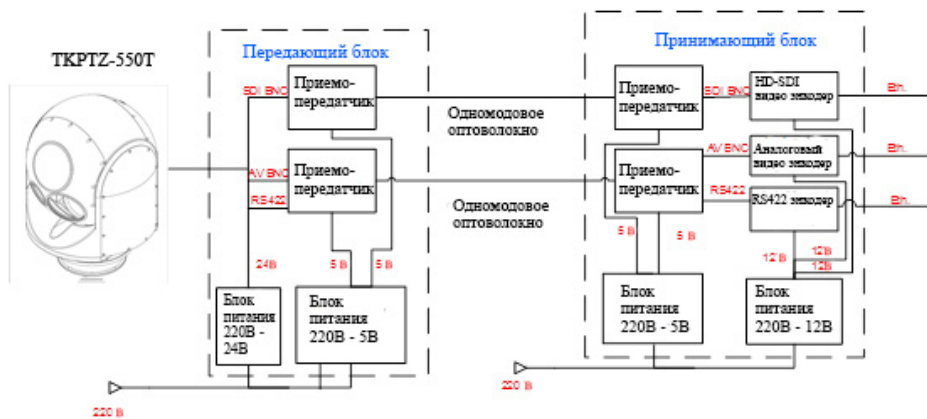
Рис. 2.2.2- Принципиальная схема подключения системы ТКРПТЗ-550Т
