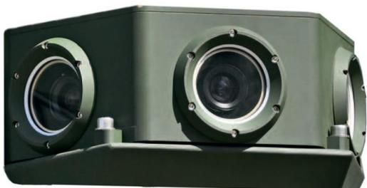
Система кругового обзора и обнаружения (СКОО) предназначена для обеспечения собственной безопасности стационарных и подвижных объектов малых и средних размеров, включая автотранспортные средства специального назначения (ТИГР, Камаз и пр.), бронемашин (танки, БТРы и пр.) и беспилотники.
