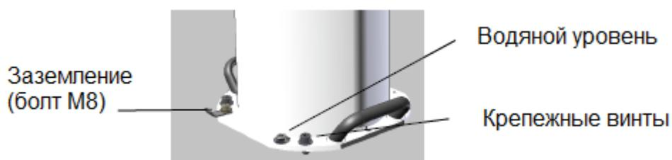
Рис. 3.1.1.1 Нижняя часть поворотной (сканирующей) платформы ОТКО
