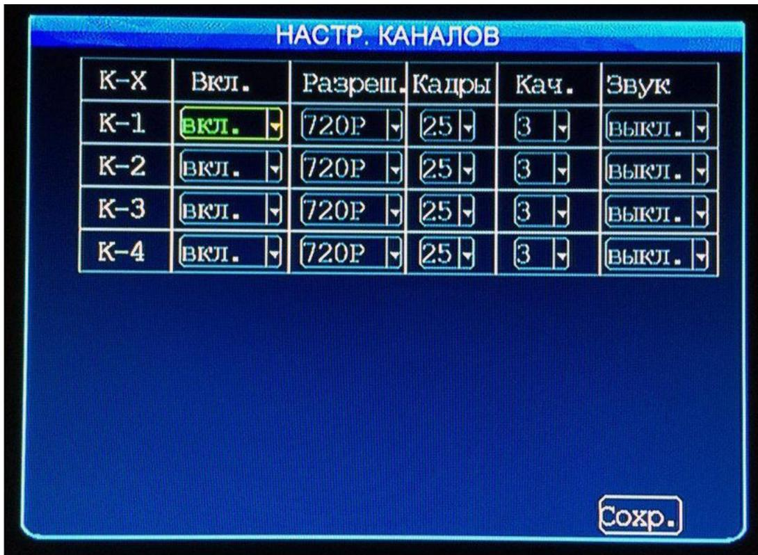
Рис. 3.5.2.1- Настройка каналов на примере TKDVR-420
