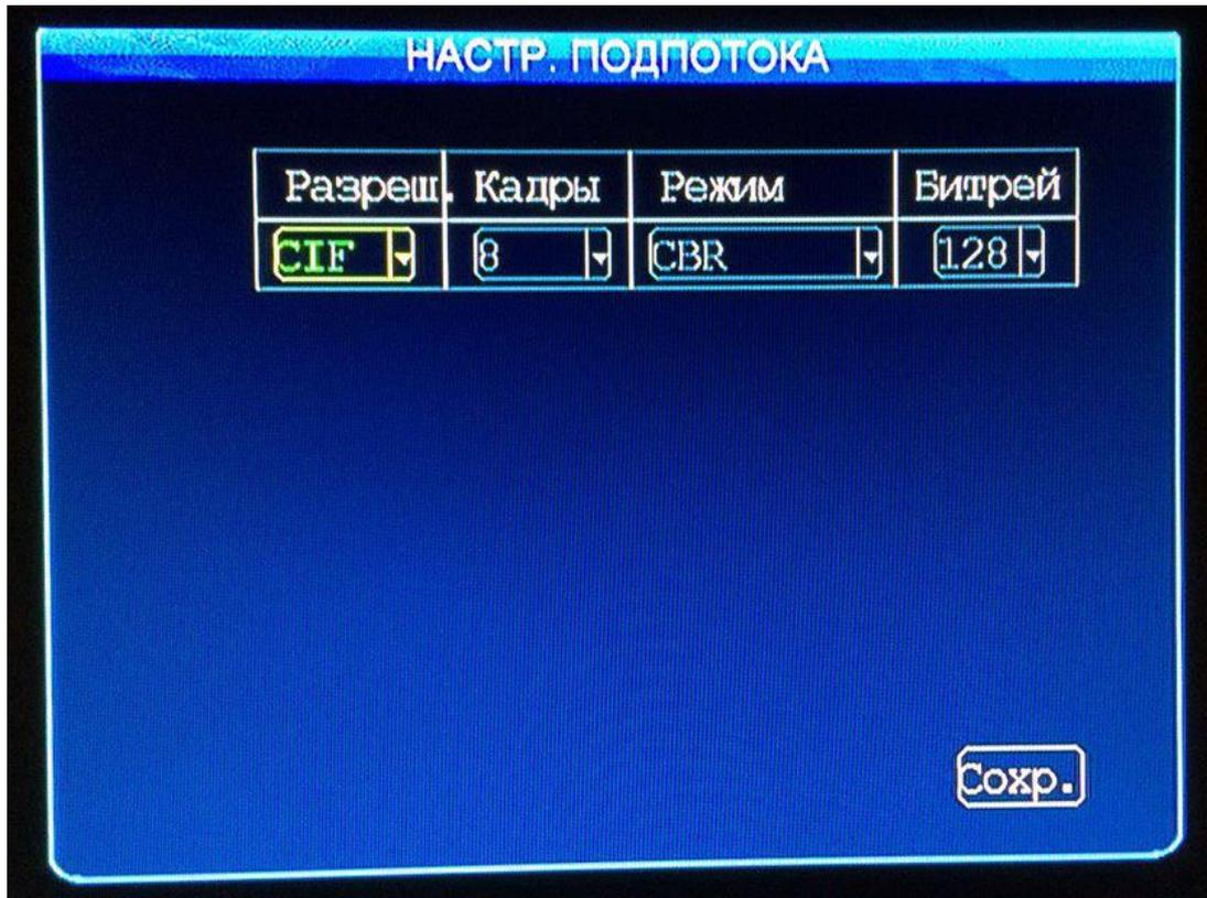
Рис. 3.5.3.1 – Настройка дополнительного потока
