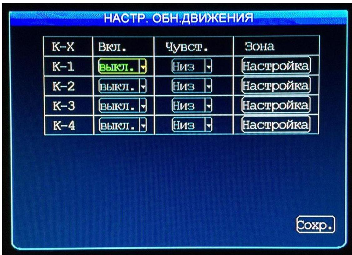
Рис. 3.6.5.1- Настройка обнаружения движения на примере TKDVR-42X
