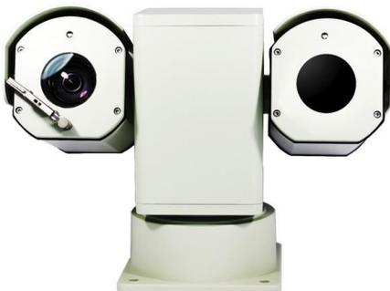
Поворотный оптико – электронный комплекс ТКРТЗ-700Т предназначен для круглосуточного и всепогодного наблюдения на больших территориях. Комплекс обеспечивает обзор 360° в горизонтальной и вертикальной плоскостях благодаря поворотной-наклонному (PTZ) механизму, а также изменению настроек двойной системы видеонаблюдения, стоящей из неохлаждаемого тепловизора и аналоговый видеокамеры.
